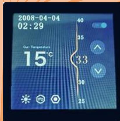
Ici, la température de consigne (souhaitée) est de 33 degrés et la température de l'eau est de 15 degrés.
