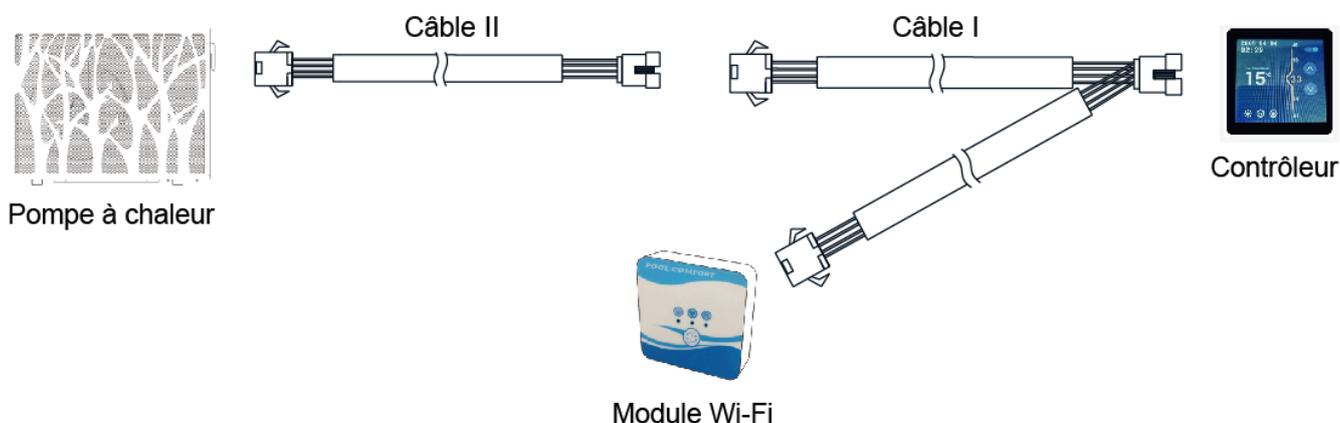
Veuillez débrancher le câble reliant le contrôleur et le circuit imprimé à travers les connecteurs. Le câble I (fiche femelle) est connecté au contrôleur . La première fiche male est connectée avec le câble du circuit imprimé et au câble II (longueur 15m). La seconde connecté au module Wifi.
