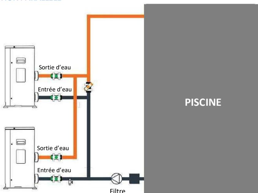
Le filtre doit être nettoyé régulièrement pour s'assurer que l'eau du système est propre et pour éviter tout problème lié à la saleté ou l'obstruction du filtre.
