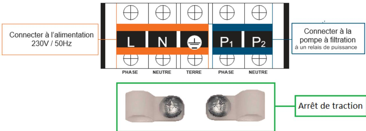
**Étape 7 :** Retirer le cache de protection de l'écran présent sur la pompe à chaleur en retirant les vis dans le cache. Puis raccorder votre câble d'extension fournit dans vos accessoires (câble I et câble II) et module Wi-Fi comme indiqué sur le schéma ci-dessous :
