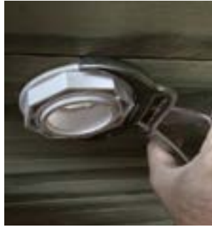
Serrer à l'aide d'une pince l'écrou
