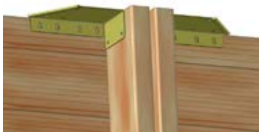
Figure 18 - Mise en place des équerres de margelles en haut des jambes de force
