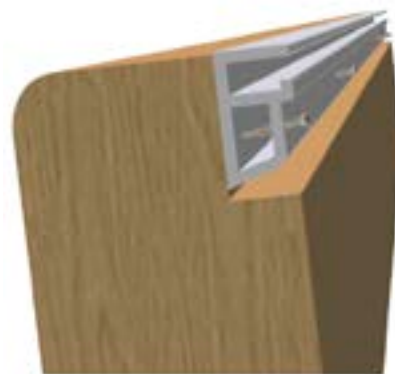
Figure 26 - Pose du rail d'accrochage
