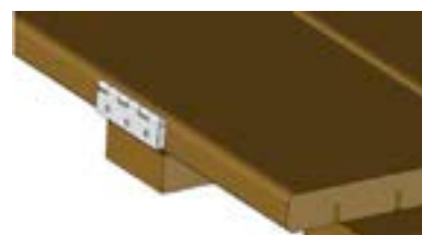
Figure 33 – Mise en place des charnières sur les caillebotis
