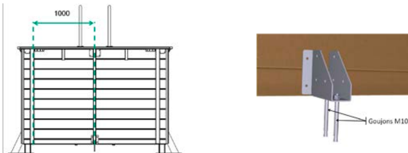
Figure 12 - Pose des sabots pour jambes de force en bois
