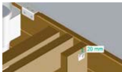
Figure 35 – Positionnement de la gâche de serrure
