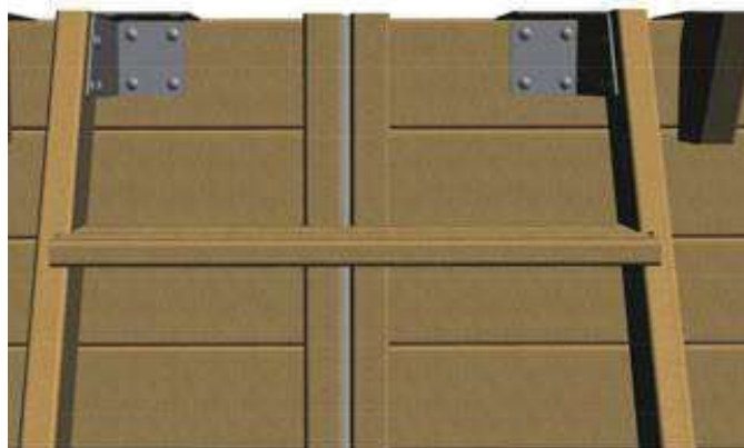
Figure 16 – Fixation de l'escalier extérieur sur le bassin
