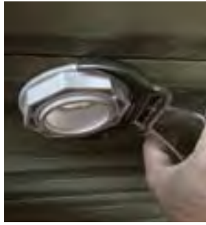
Serrer à l'aide d'une pince l'écrou
