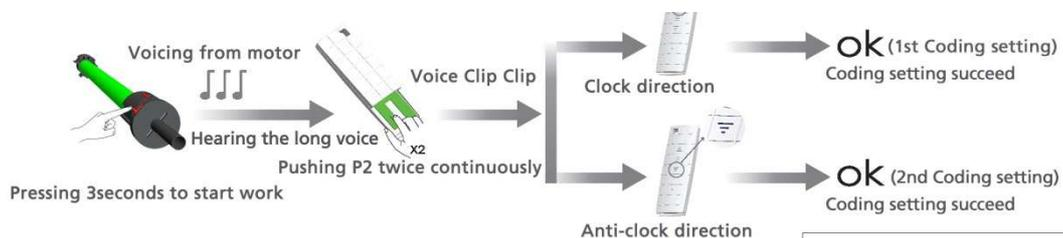
Appuyer pendant 5 secondes sur le bouton situé sur le moteur. Attendre le bip et le mouvement du moteur avant de relâcher.
