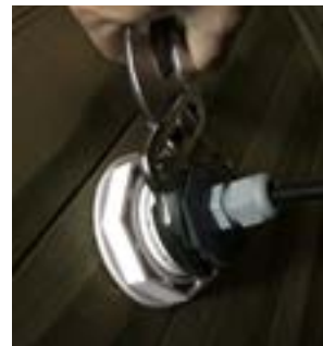
Serrez le raccord à l'aide d'une pince
