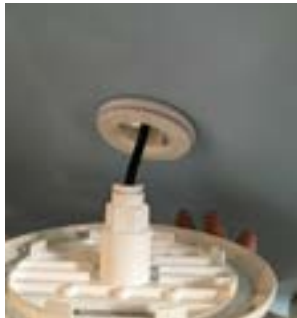
Serrer à l'aide d'une pince l'écrou
