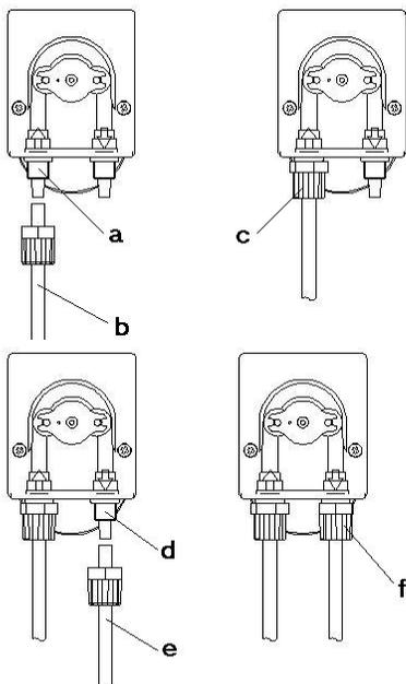
**F** Aspiration: Raccorder le tuyau d'aspiration (b) au raccord d'aspiration (a).
