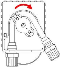
**F** Positionner le raccord de gauche du nouveau tube péristaltique dans l'encoche prévue à cet effet. Faire attention à ce que la partie arrondie soit orientée vers l'intérieur. Tourner le porte-galet dans le sens horaire de façon à ce que le tube péristaltique se mette naturellement en place.
