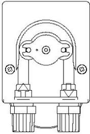
**F** Insérer le raccord de droite dans l'encoche prévue. Positionner le couvercle sur la pompe et le fixer à l'aide des deux vis.
