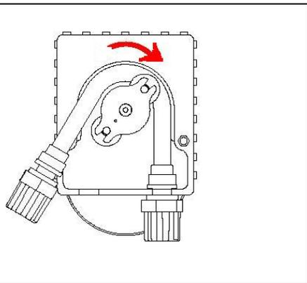
**F** Enlever le couvercle transparent en dévissant les deux vis. Enlever le vieux tube en débloquent d'abord le raccord de gauche. Faire tourner le porte-galet dans le sens de la flèche jusqu'au raccord de droite afin de libérer le tube péristaltique.
