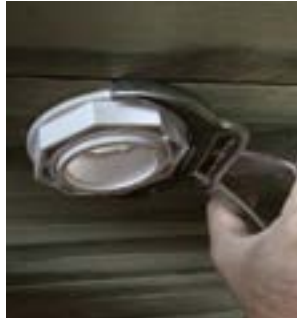
Serrer à l'aide d'une pince d'une écrou
